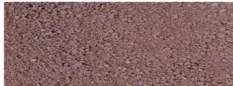
Piste ciclabili in asfalto bituminoso pigmentato
