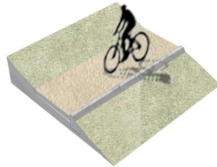
Percorsi in Sabbia compattante/macadam\_canalina di drenaggio e muro di contenimento in pietra
